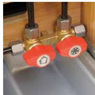
Zentrale Regulierung der Gaszufuhr Gaszufuhr - Gashaner
